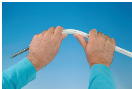
Гибка с помощью внутренней гибочной пружины
